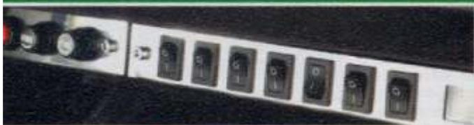
Schaltwerk: Vom Handschuhfach aus lassen sich die einzelnen Kanäle bequem ein- und ausschalten.
