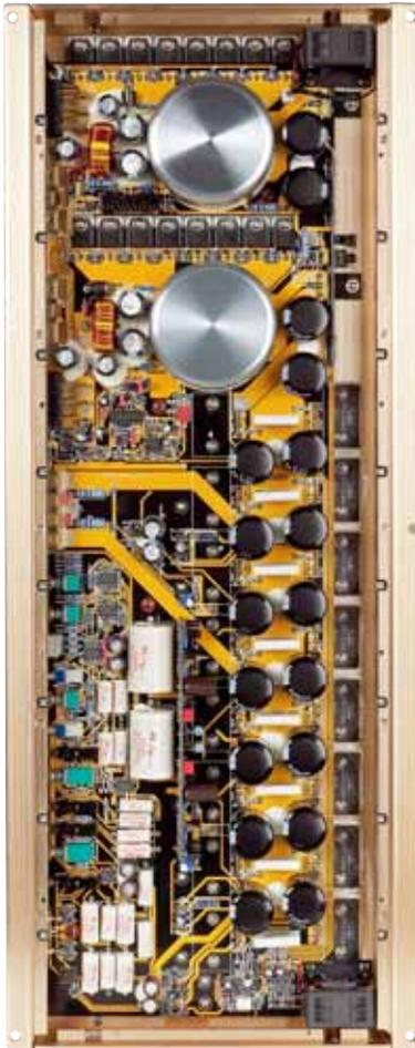
Die getrennten Netzteile für rechts und links benötigen jeweils eine eigene Stromversorgung
